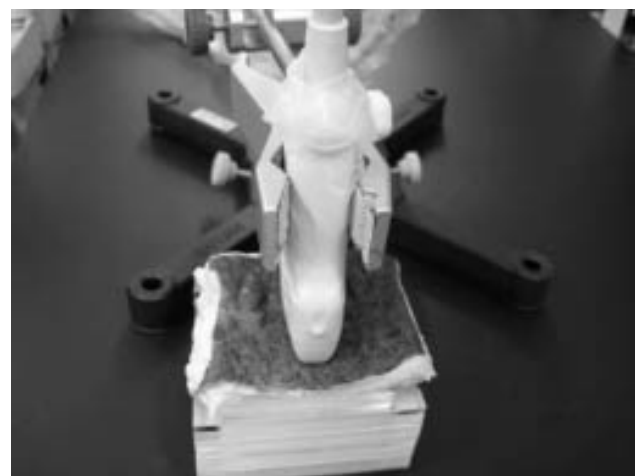
図3 本研究に用いられた石灰化ファントム。 Fig. 3. Calcification phantom used in this study.
